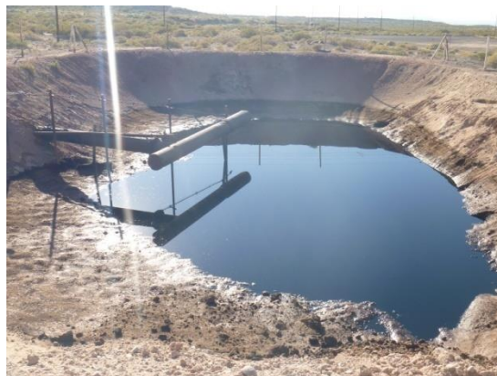
Se observa incidente en fosa de venteo, afectando suelo en instalación.
